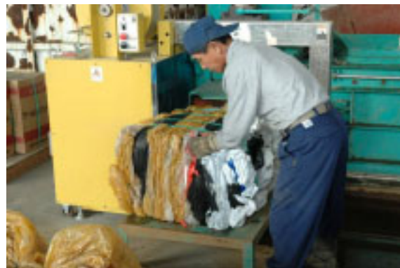
梱包材の圧縮梱包状況
