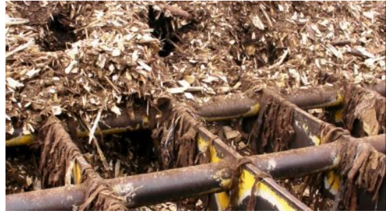
使用している燃料チップ。切削皮付き（？）に近いが破碎らしい。スリーパー、パークもお構いなし。
